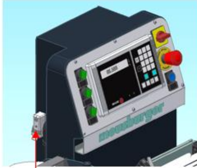
3A-Anbaugehäuse 230V/16A 50Hz für Kühlmittelpumpe
